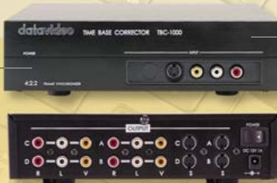
Sul retro del VP299 e del TBC1000 sono presenti 4 prese d'uscita di tipo RCA ed altrettante di tipo S-VHS.
