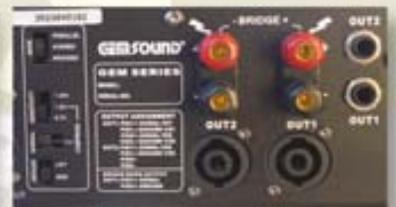
*Sono presenti numerosi tipi di connettore in uscita per permettere di collegare agevolmente ogni tipo di box, sia che esso presenti connettori a "banana" sia "Jack 6,3mm" piuttosto che "speak-on".*
