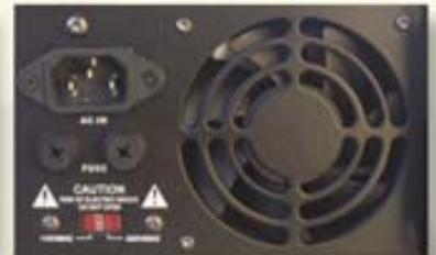
*Sotto alla presa di alimentazione si scorgono i due fusibili indipendenti di sicurezza che intervengono in caso di sovraccarichi di tensione improvvisi.*
