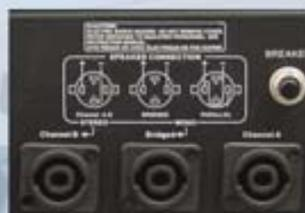
Le uscite, sono indicate da un pratico schema che indica il corretto collegamento dei cavi per ogni tipo di utilizzo.
