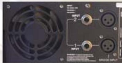
*I connettori di ingresso sono di tipo sia sbilanciato (Jack 6,3mm) che bilanciato (connettori XLR). E' possibile impostare l'amplificatore per uso in modalità Parallela, Stereo o Bridged.*
