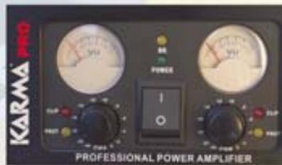
*I Vu-meters permettono un preciso controllo sul livello del segnale in uscita mentre i leds segnalano sovraccarichi e distorsioni.*
